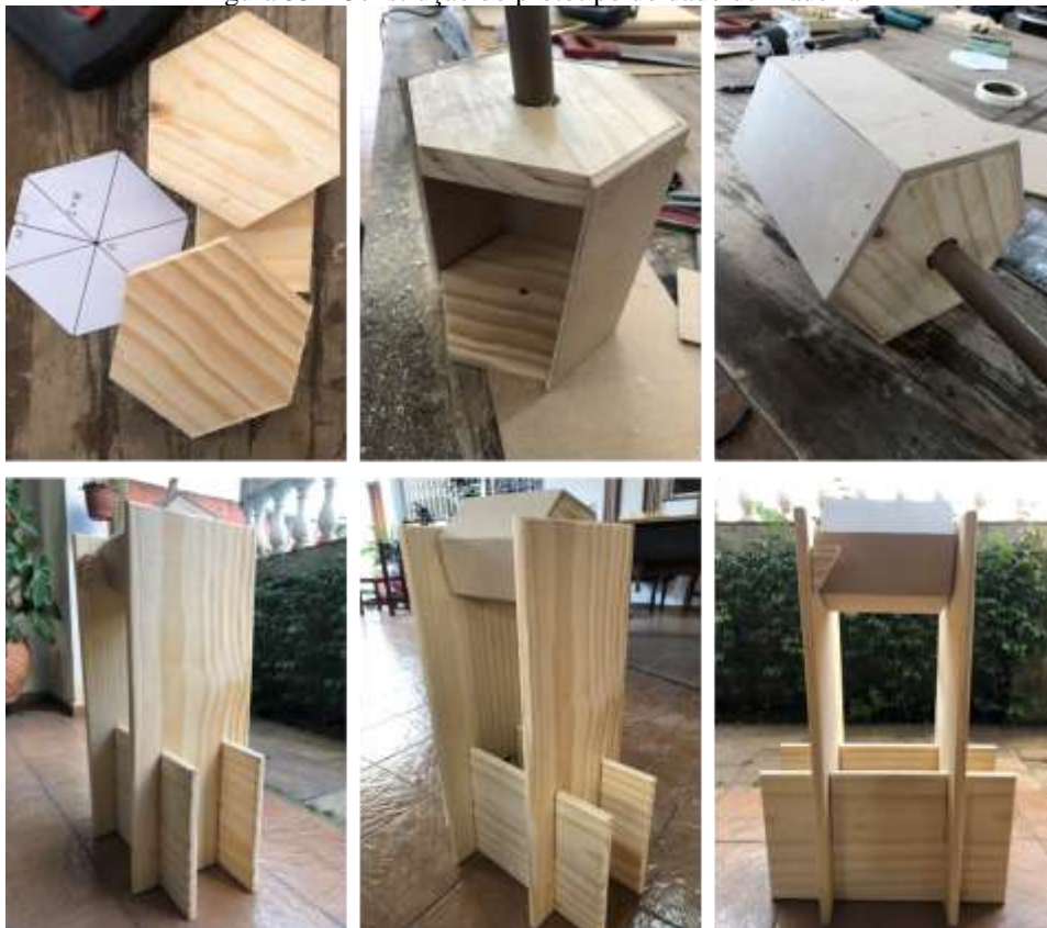
Figura 35 - Construção do protótipo do dado de madeira
